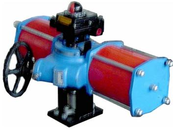
结构轻巧，输出力矩大，含有手操和阀位指示。双作用型式，工作转角  $0\sim 90^\circ$ 。操作压力  $0.4\sim 0.6\text{MPa}$ ，可带定位器、空气过滤减压器等附件。弹簧复位单作用型号为 ZSCs。
