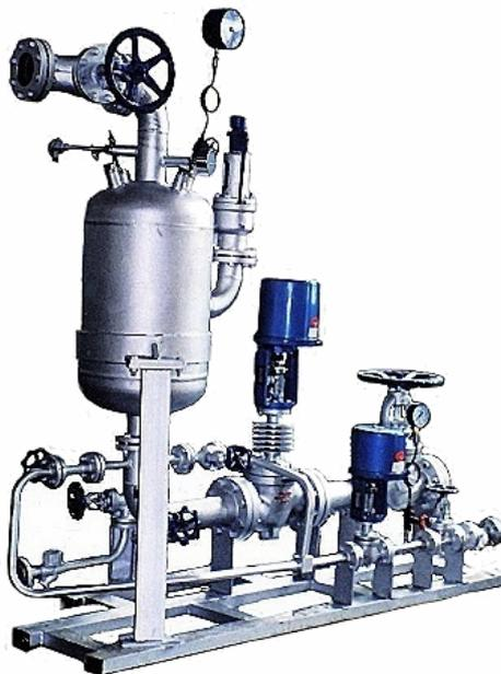
采用电子式电动阀减压、减温，阀的结构为平衡式，耐气蚀，低噪音，装有扩容箱，保证新蒸汽品质，整套装置为撬式结构，安装紧凑而方便。
