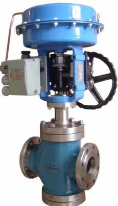
执行机构为薄膜式多弹簧可调零，双导向平衡式结构，许用压差大，泄漏Ⅲ级。气关气开对应配正反作用执行机构，调节稳定                                                                                 | 压差大、流量大而泄漏要求不严的场合。                                              |
