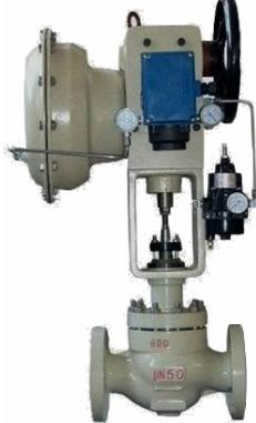
由ΣF 执行机构和顶导向单座（套筒）调节阀组成。低噪音、抗气蚀，抗高压差、泄漏小，使用面宽，阀芯阀座真空熔烧硬质合金，使用寿命长，弹簧范围：<br>气关 20 ~ 100；<br>气开 80 ~ 200kPa。<br>气源 240 kPa。                | 石油、化工、电站、冶金、制药、造纸、染料等工业生产自控系统中。                                 |
