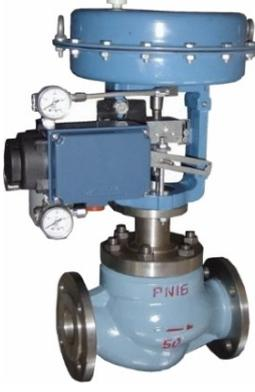
执行机构为薄膜式多弹簧可调零，单座泄漏为Ⅳ级，许用压差小。双座、套筒为力平衡结构，泄漏大、许用压差大，噪声低，抗振性好、寿命长（可做成低噪音结构）稳定性好。弹簧范围：20 ~ 100； 40 ~ 200； 80 ~ 240kPa。变型产品有多级降压、防噪结构，保温夹套等， | 石油、化工、电站、冶金、制药、造纸、染料等工业生产自控系统中。                                 |
