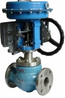
执行机构为薄膜式多弹簧可调零，弹簧范围：20 ~ 100； 40 ~ 200； 80 ~ 240kPa，结构紧凑，泄漏Ⅳ级，S 流线形通道，压损小、流量大、抗振性好、可调比大、流量特性精度高。                                          | 控制各种不同压力和温度、泄漏要求严、压差不大的流体。<br>用于石油、化工、电站、冶金、制药、造纸、染料等工业生产自控系统中。 |
